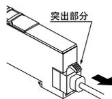
注：请注意如果不按下突出部分就拉出连接器，突出部分可能被损坏。请勿使用突出部分已损坏的单触电缆。
