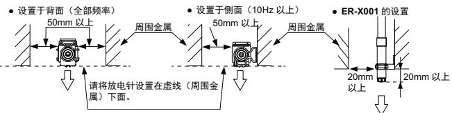
(注 5) : 并排安装 2 个以上的除电头时，应设定为相同频率，并按照下图所示的间隔进行安装。
