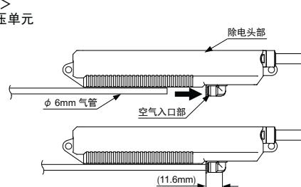
(注 1) : 将管子插入本产品的接头后, 一定要将管子插到尽头, 请确认管子确实已经插好。
