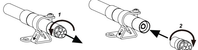
(注 1)：禁勿在放电针单元还没插入到底状态时使用。可能造成事故或故障的原因。
